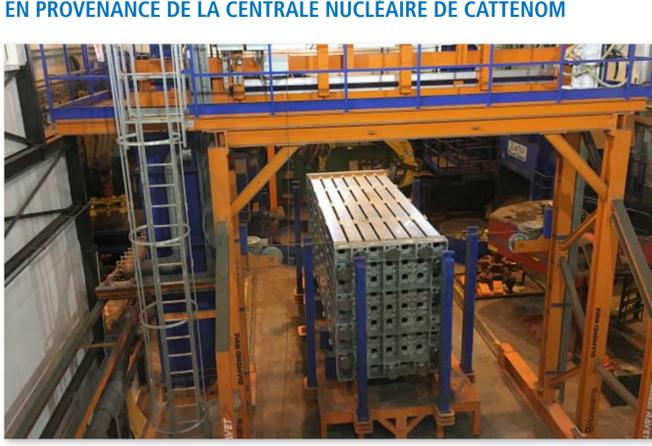
Ce rack est en cours de traitement dans l'atelier conçu à cet effet au sein de l'usine. Le métal mis au gabarit du four de fusion de CENTRACO sera fondu et transformé en lingots.
